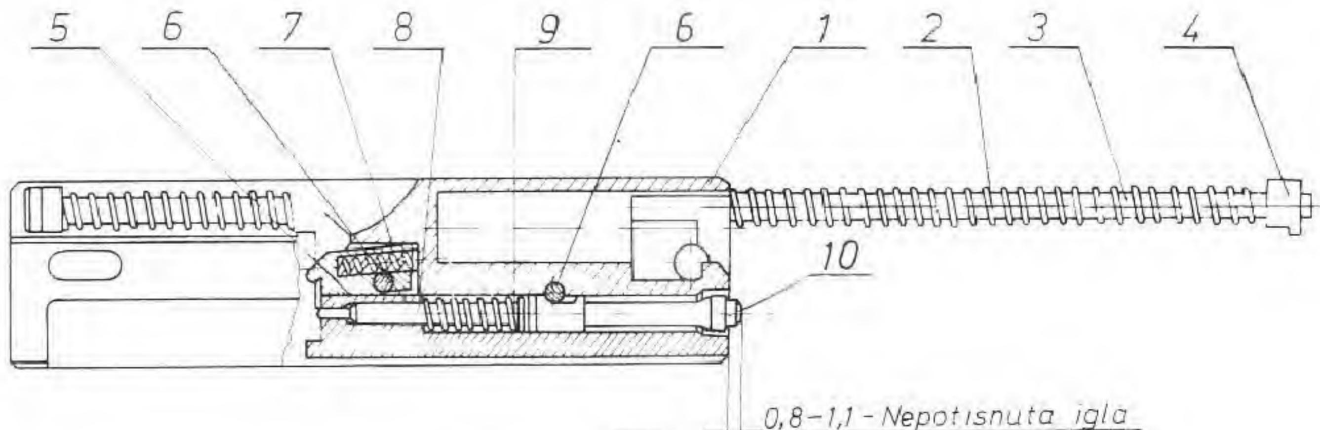
Sl. 38 – Sklop zatvarača sa opružnim povratnikom:
